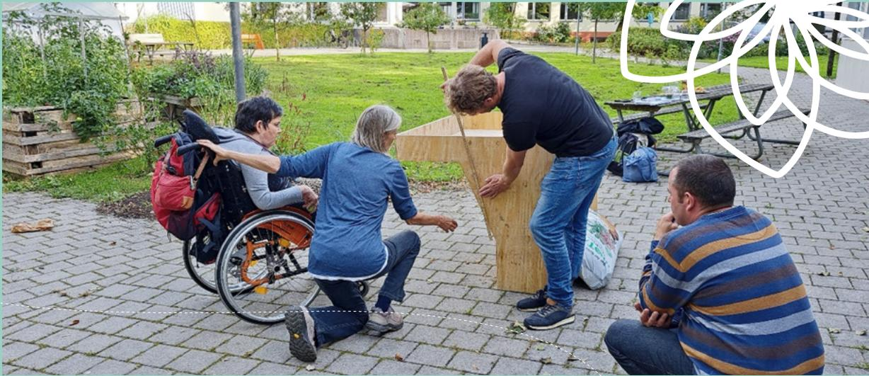
An einem Prototypen wird genau vermessen, wie viel Bewegungsraum ein unterfahrbares Hochbeet benötigt.
